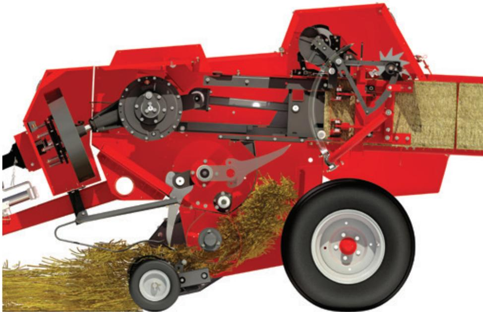
Das Erntegut wird vom neuen Raffer direkt von der Pickup in die Vorpresskammer geschoben. Dabei sorgen die "aufwärts" rotierenden Querschnecken für eine enorme Einzugsleistung!
