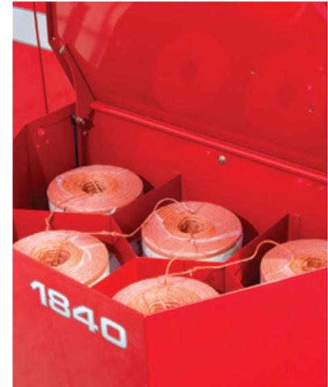
Die MF 1840 kann 10 Garnrollen mitführen, genug selbst für längste Arbeitseinsätze. Durch die großen Abmessungen der einzelnen Fächer können auch, XL Garnspulen verwendet werden, wodurch noch mehr Garn mitgeführt werden. Dies ermöglicht besonders langes Arbeiten mit der Presse ohne jegliche Unterbrechung!
