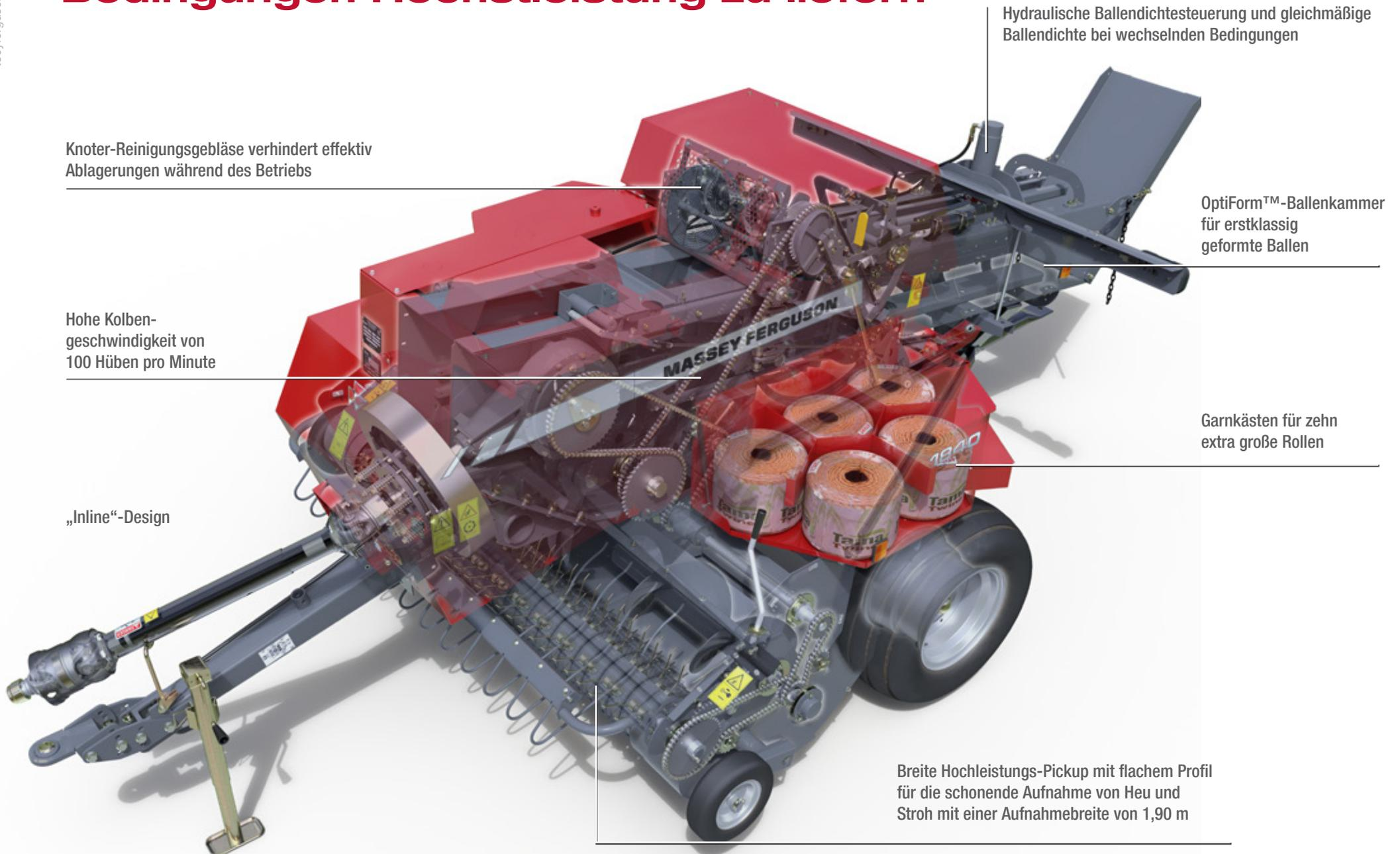
Hydraulische Ballendichtesteuerung und gleichmäßige Ballendichte bei wechselnden Bedingungen
