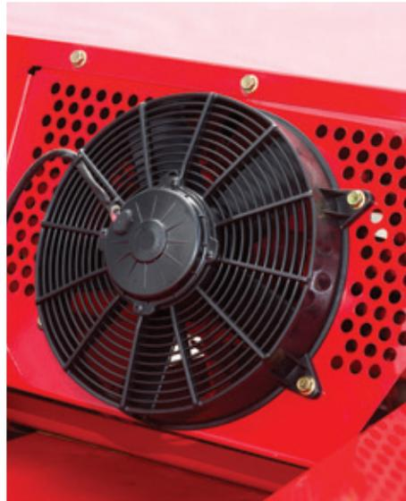
Die MF 1840 ist serienmäßig mit einem elektrischen Knotergebläse ausgestattet. Es gewährleistet, dass die Knoter während des Betriebs sauber und frei von Ablagerungen.
