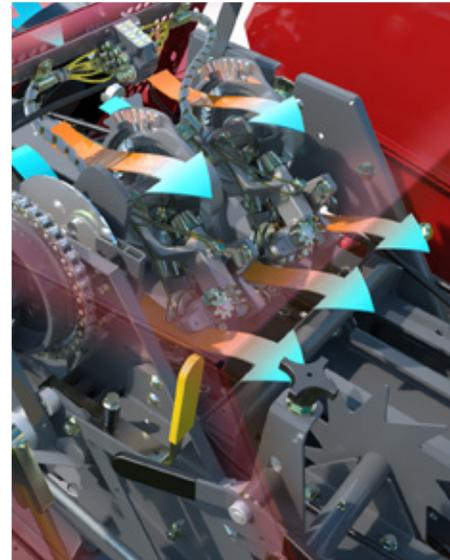
Die Luft wird vorn angesaugt, strömt über die Knoter und wird über die Rückseite der abgeleitet.
