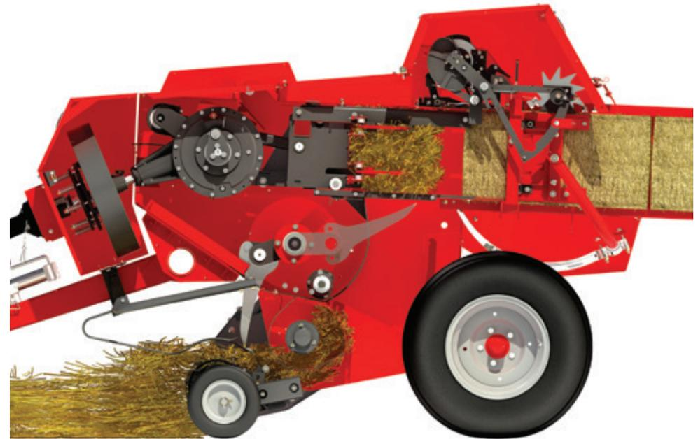
Der Antrieb ähnelt stark dem einer Großballenpresse. Er ist mit 100 Hüben pro Minute auf geringe Wartung, hohe Leistung und lange Lebensdauer ausgelegt.
