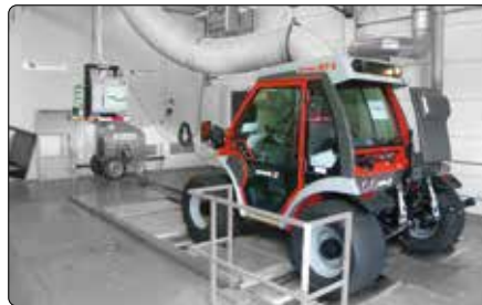
Alle Fahrzeuge werden vor der Auslieferung einer intensiven Funktionsprüfungen wie z.B. Rollenleistungsprüfstand (Bild) unterzogen.
