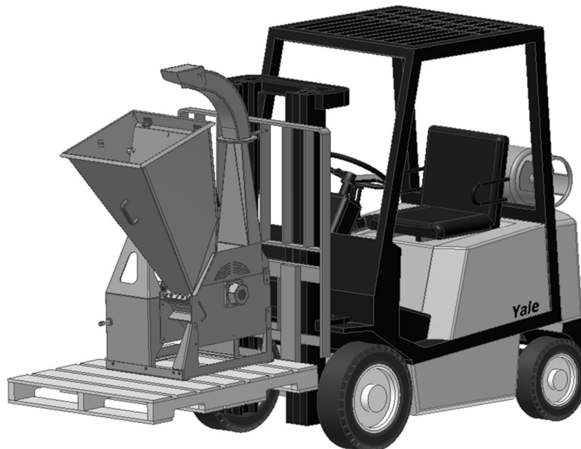
Abb. 3 Anheben mittels Gabelstapler, PTO
