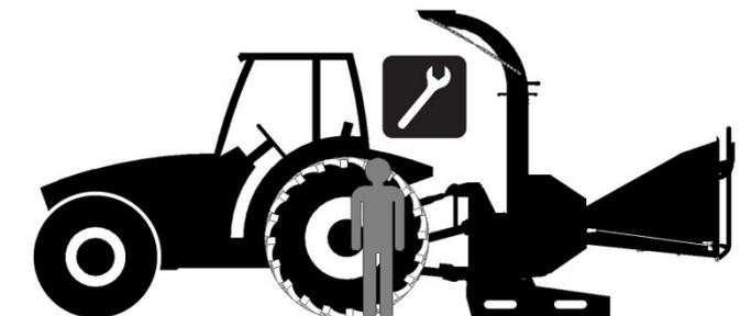
Führen Sie **NIEMALS** Wartungs- oder Reparaturarbeiten am Holzhacker durch, solange dieser noch mit dem Traktor verbunden ist.
