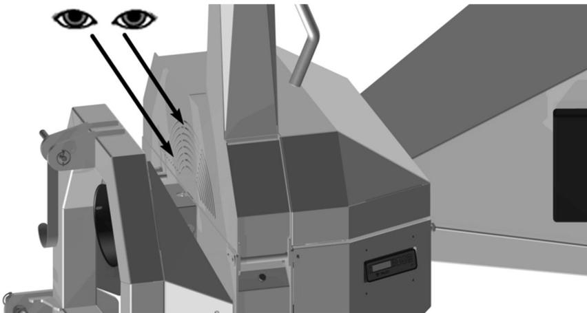
3. Drehen Sie das Auswurfrohr so, dass es vom Rotorgehäuse weg zeigt (siehe Abbildung unten).
