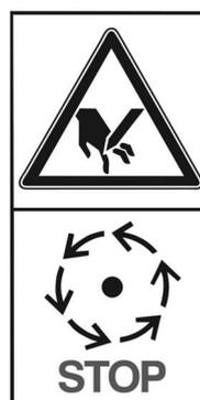
Entfernen oder öffnen Sie **NIEMALS** die Schutzabdeckungen, solange die Rotorscheibe noch nicht zum Stillstand gekommen ist und die Gelenkwellenverbindung noch nicht getrennt wurde.
