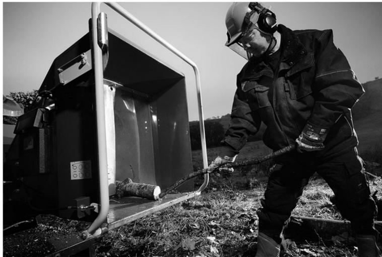
Verwenden Sie **STETS** einen Ast, um kurze Baumstücke in die Walzen zu schieben.
