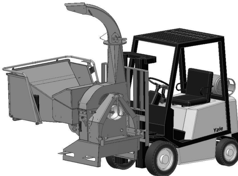
Abb. 4 Anheben mit Gabelstapler
