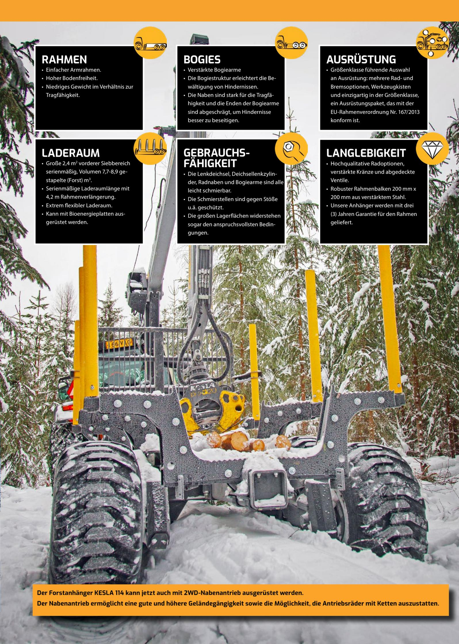
Der Forstanhänger KESLA 114 kann jetzt auch mit 2WD-Nabenantrieb ausgerüstet werden.
